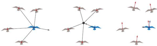
Abb. 15: Die drei Regeln des BOIDS-Algorithmus. Separation, Kohäsion und Aligment. (von links)
