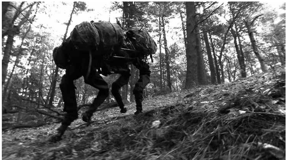
Zivile oder militärische Forschung, Internetkonzern oder Robotik-Unternehmen? Grenzen verschwimmen, Kontrollmöglichkeiten auch. Der vierbeinige Roboter BigDog kann beladen durch unwegsames Gelände sowie auf Schnee und Eis laufen. Google kaufte die Firma Boston Dynamics, die mit Prototypen laufender Maschinen für das US-Militär bekannt geworden ist.
